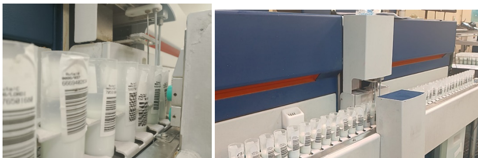
Figura 2. Procesado de muestras de leche y análisis FT-MIR en el laboratorio LILCAM.
